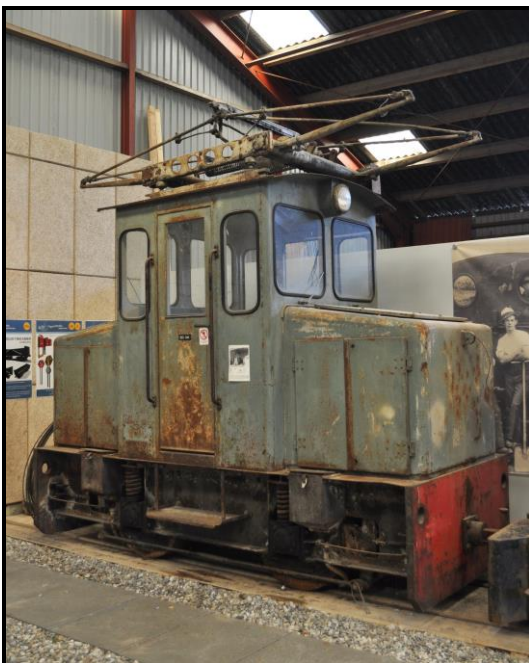
Det elektriske lokomotiv fra Rørdal Cementfabrik. Lokomotivet er bygget af ASEA i 1961. Sporvidden er 785 mm.
