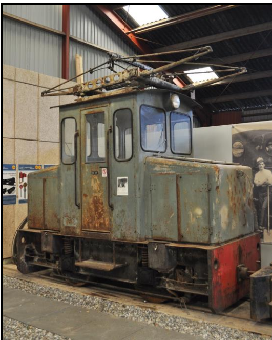
Det elektriske lokomotiv fra Rørdal Cementfabrik. Lokomotivet er bygget af ASEA i 1961. Sporvidden er 785 mm.
